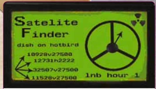
■ Layar pada Pencari Satelit Pintar menampilkan transponder yang paling kuat beserta skew LNB.
