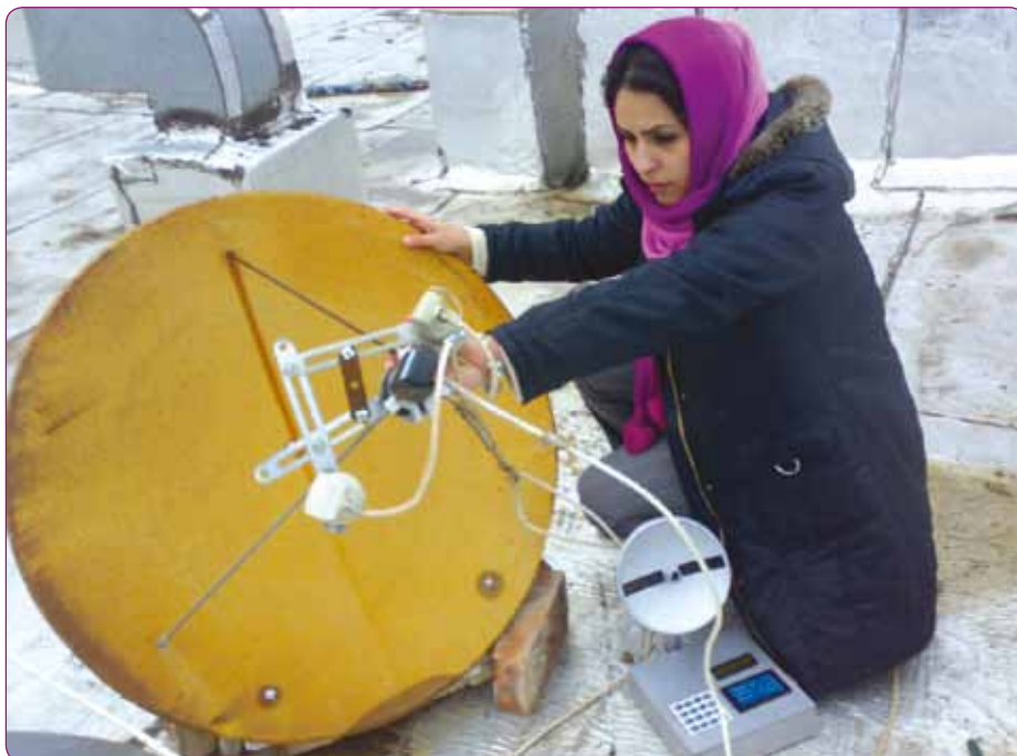
■ Beginilah cara Pencari Satelit Pintar digunakan: yaitu menunjukkan posisi satelit yang akan diterima dan antena sebenarnya diarahkan paralel terhadap alat ini.
