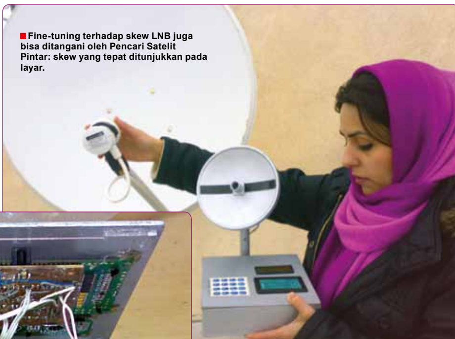
■ Beginilah cara Pencari Satelit Pintar digunakan: yaitu menunjukkan posisi satelit yang akan diterima dan antena sebenarnya diarahkan paralel terhadap alat ini.
