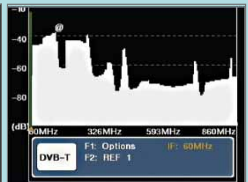
Frekuensi yang aktif bisa secara mudah dikenali dalam tampilan alat analisa spektrum
