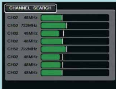
Pencarian multi-saluran untuk DVB-T memungkinkan Anda melihat kualitas sinyal dari 8 saluran secara bersamaan
