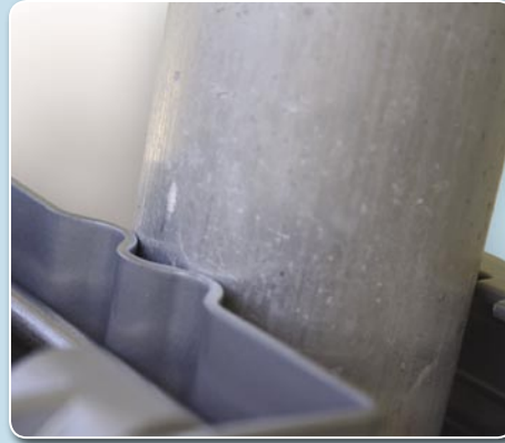
Tanda untuk pengaturan motor pada tiang, yang mengarah ke Selatan
