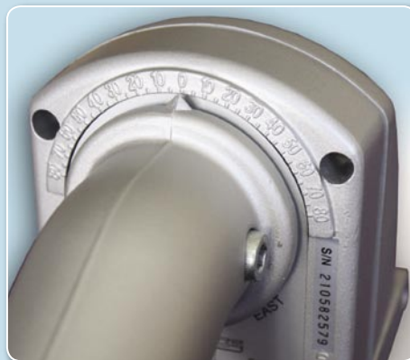
Skala sudut rotasi pada motor
