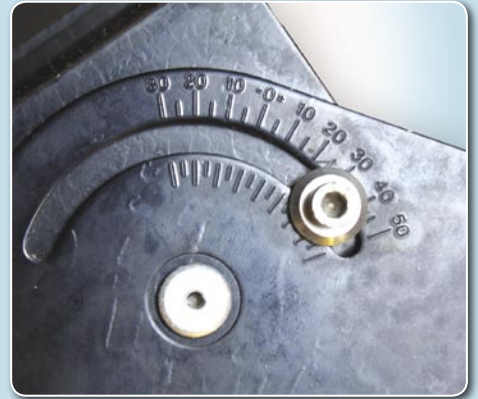
Nilai elevasi yang diatur pada antenna
