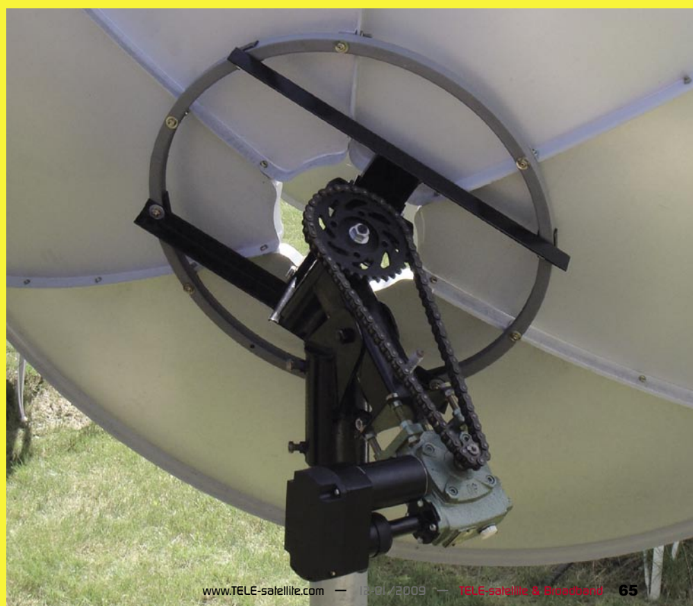
■ Motor dari PT Subur Semesta dengan rantai transmisi dari kotak gir ke aksis.
