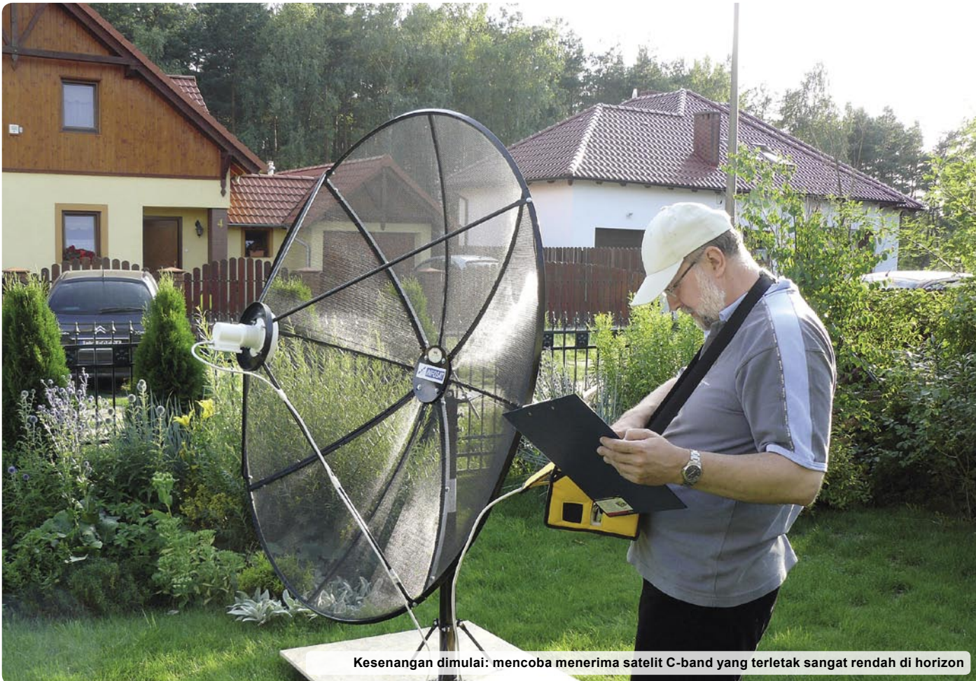
Saatnya untuk mengatur arah antena. Kami merekomendasikan untuk memakai waterpass yang dilengkapi dengan meter sudut – akan memudahkan pengaturan elevasi.
