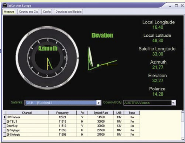
Aplikasi komputer untuk memilih salah satu lokasi dan untuk menghitung sudut yang diperlukan.
