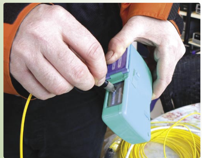
Pesan untuk para instalatir: Jangan terburu-buru mencolokkan kabel optikal – koneksi kabel perlu dibersihkan terlebih dahulu sebelum dihubungkan. Berbagai metode dapat digunakan untuk hal ini; yang paling praktis adalah menggunakan perangkat yang ditunjukkan di sini: Konektor kabel serat optik diselipkan.
