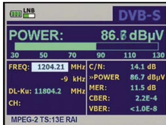
Pengukuran sinyal dari transponder RAI di HOTBIRD 13° BT. LNB konvensional tunggal (kiri) dan LNB optikal Global Invacom (kanan) |
