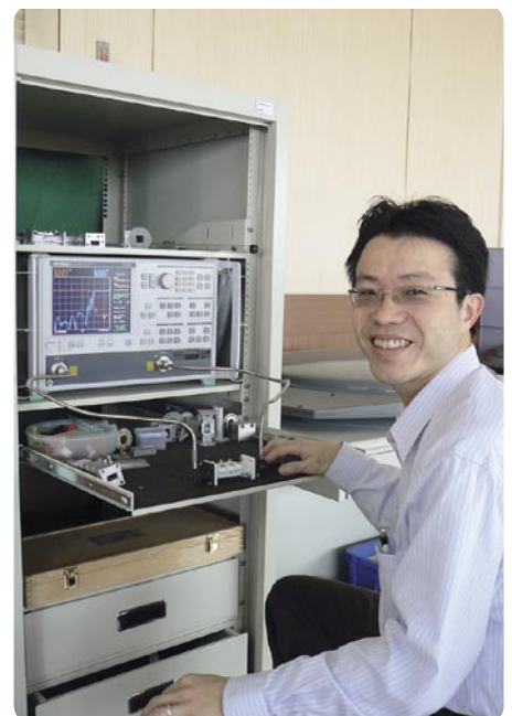
Karyawan R&D mengukur sampel OMT. Antena VSAT dibuat lengkap dengan OMT dan feed.
