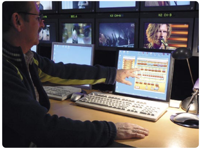
▲ Direktur Teknis Jacques Schepers memeragakan inti dari playout: sinyal dapat disalurkan ke dua transponder Astra, transponder Eutelsat atau ke jaringan kabel dengan klik mouse.
