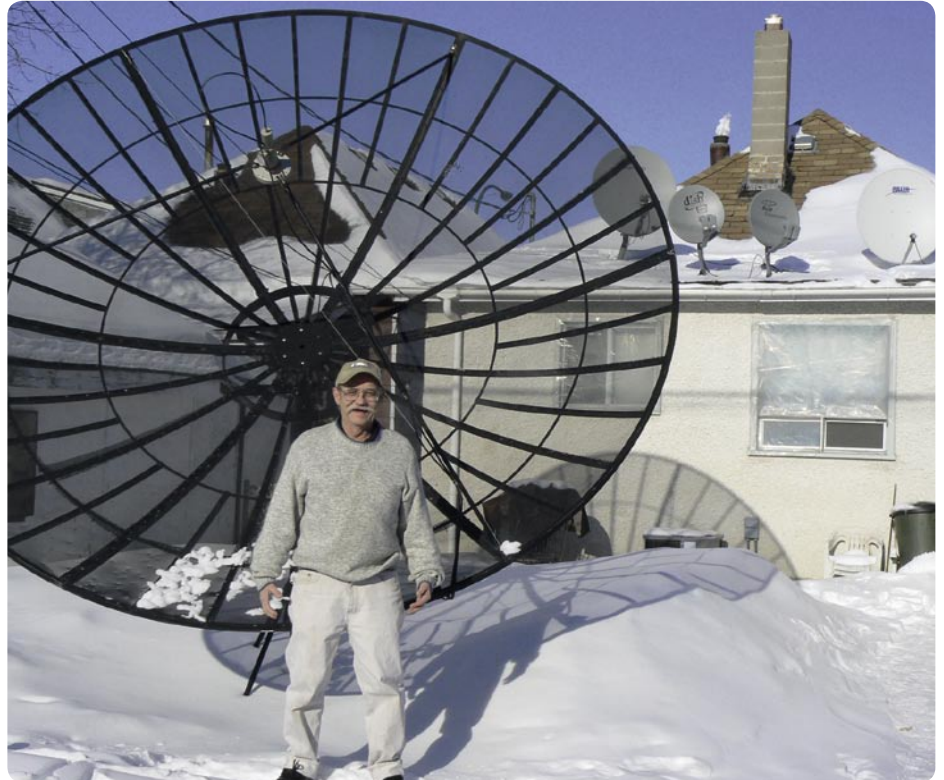
Pada usia 60 tahun, Jerry baru saja memulai. Dia berdiri di halan di depan antena 3,6 meter miliknya. Dia mengganti wire mesh pada antena ini tahun lalu. Dia memiliki LNB C/Ku-band dengan actuator dari pabrikan VonWeise di St. Louis, Amerika. Satelit favoritnya adalah SatMex 5, G3, AMC1 dan Galaxy 4. Antena 100cm dengan motor dipasang
