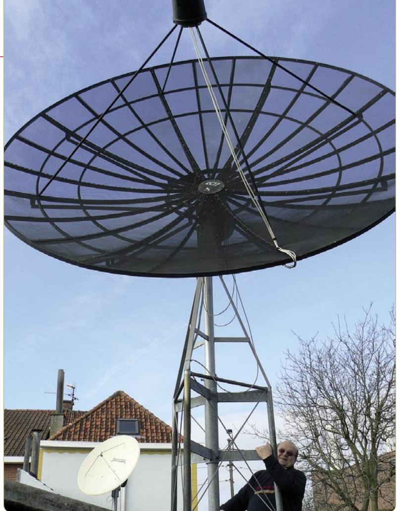
Antena Aimé sangat besar dan sangat sulit memadukan kepala LNB (atas) dan kepala Aimé (bawah) dalam satu gambar. Pada bagian kiri adalah latar belakang dengan antena 1,8m dengan motor untuk Ku-band.
