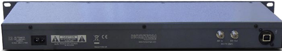
Tampak belakang pembaca transport stream dengan antarmuka USB kedua dan masukan antenna. Yang lainnya ditangani oleh peranti lunak TSReader dari Rod Hewitt
